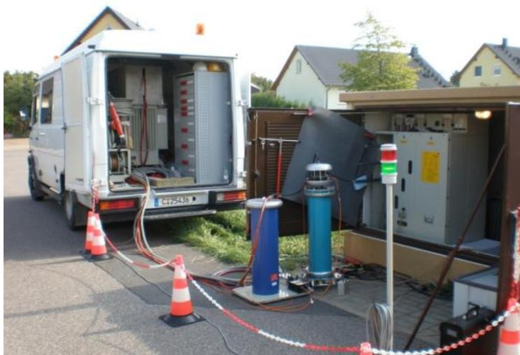
**Abbildung:** Mobiles Resonanzprüfsystem zur Teilentladungs- und Verlustfaktormessung und Spannungsprüfung
