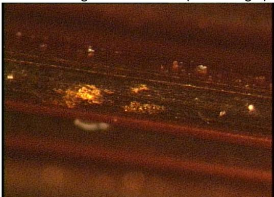
**Abbildung 3:** Durchschlag zwischen den Wickeldrähten
